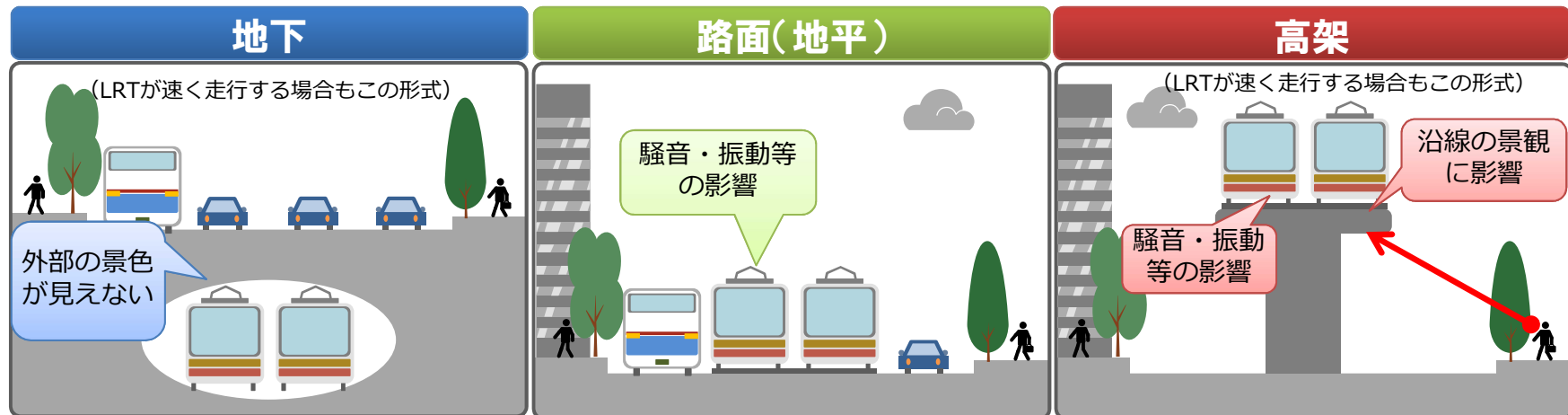
鉄軌道導入による環境、景観への影響例(地下、路面、高架)
